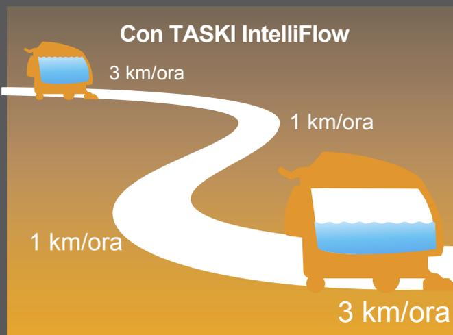
Il sistema brevettato IntelliFlow garantisce una quantità costante di soluzione detergente per m2. TASKI IntelliFlow consente di ridurre l'erogazione della soluzione in modo automatico, eliminando gli sprechi e i tempi morti di ripasso. Inoltre, riduce il consumo di acqua di oltre il 50%.
