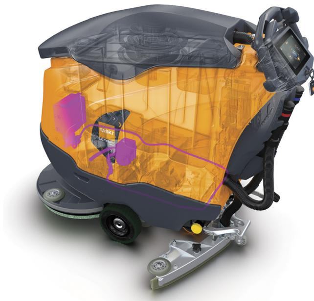
I sensori misurano il flusso d'acqua controllato di IntelliFlow. La macchina calcola la quantità di prodotto chimico necessaria ed aziona la pompa peristaltica per diluire il prodotto. Il serbatoio deve contenere solo acqua pulita.
