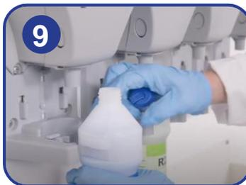
9 Coloque y vacíe la botella y / o el cubo debajo de la boquilla dosificadora
