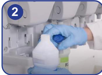
2 Coloque una botella vacía y/ o un cubo debajo de la boquilla dispensadora.
