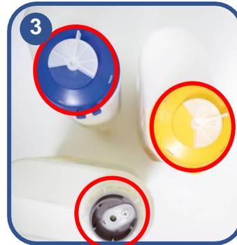
3 Placer les récipients de produit sur une surface appropriée et vérifier les bouchons pour incrustation / colmatage.
