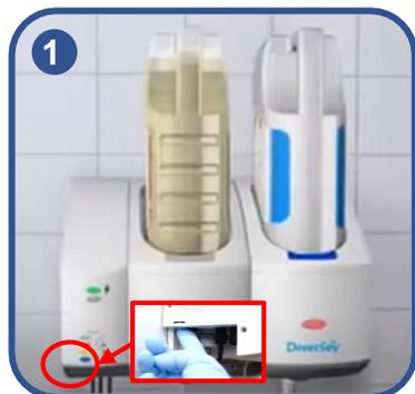
1 Eteignez le système de dosage en appuyant sur l'interrupteur ON/OFF.
