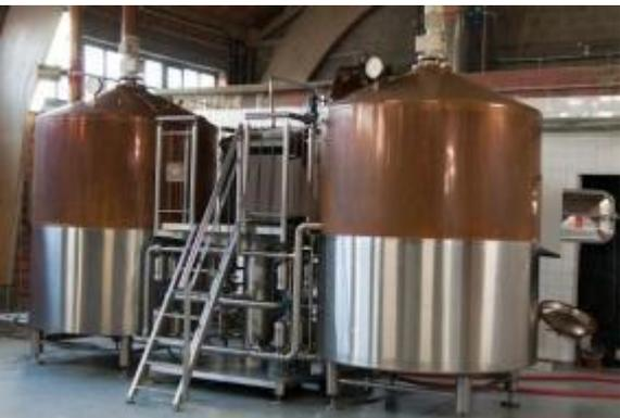
**NB :** Pour les brasseries disposant d'une eau de dureté supérieure à 20°F, compléter le nettoyage alcalin par un nettoyage acide, 1 fois par mois, avec l'ALUWASH afin d'éliminer les résidus calcaires si en circuit, sinon avec ACIPLUSFOAM en mousse:
