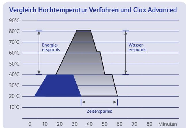
\*Vergleichswerte auf Basis jährlicher Einsparungen bei einer Temperaturreduktion von 80°C auf 60°C Grad (Test wurde bei einer Hotelkette im Europa-Raum mit 3472 Zimmern durchgeführt).
