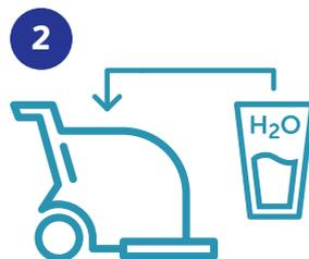
Füllen Sie den Tank mit Leitungswasser. Unter den meisten Umständen ist keine Reinigungschemie erforderlich.
